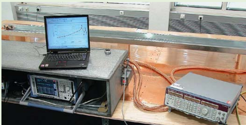
3. kép elrendezés a kábel tartó-szerkezet transzferimpedanciájának meghatározásához.
