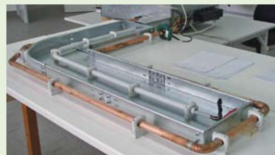
1-2. kép Mérési elrendezés a kábeltartó-szerkezet mágneses árnyékolóképességének meghatározásához.
